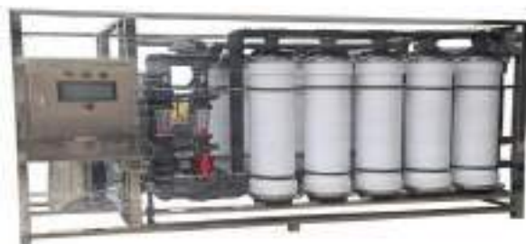
Equipo de ultrafiltración por membranas
